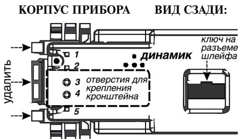
8. Устанавливаются кронштейны, как показано на рисунке 3.29. Накладываем согнутый кронштейн длинной стороной на заднюю панель, часть с большим круглым отверстием приподнята. При этом фигурный вырез кронштейна должен быть обращен в противоположную от динамика сторону. Рис. 3.28 и рис. 4.29.
