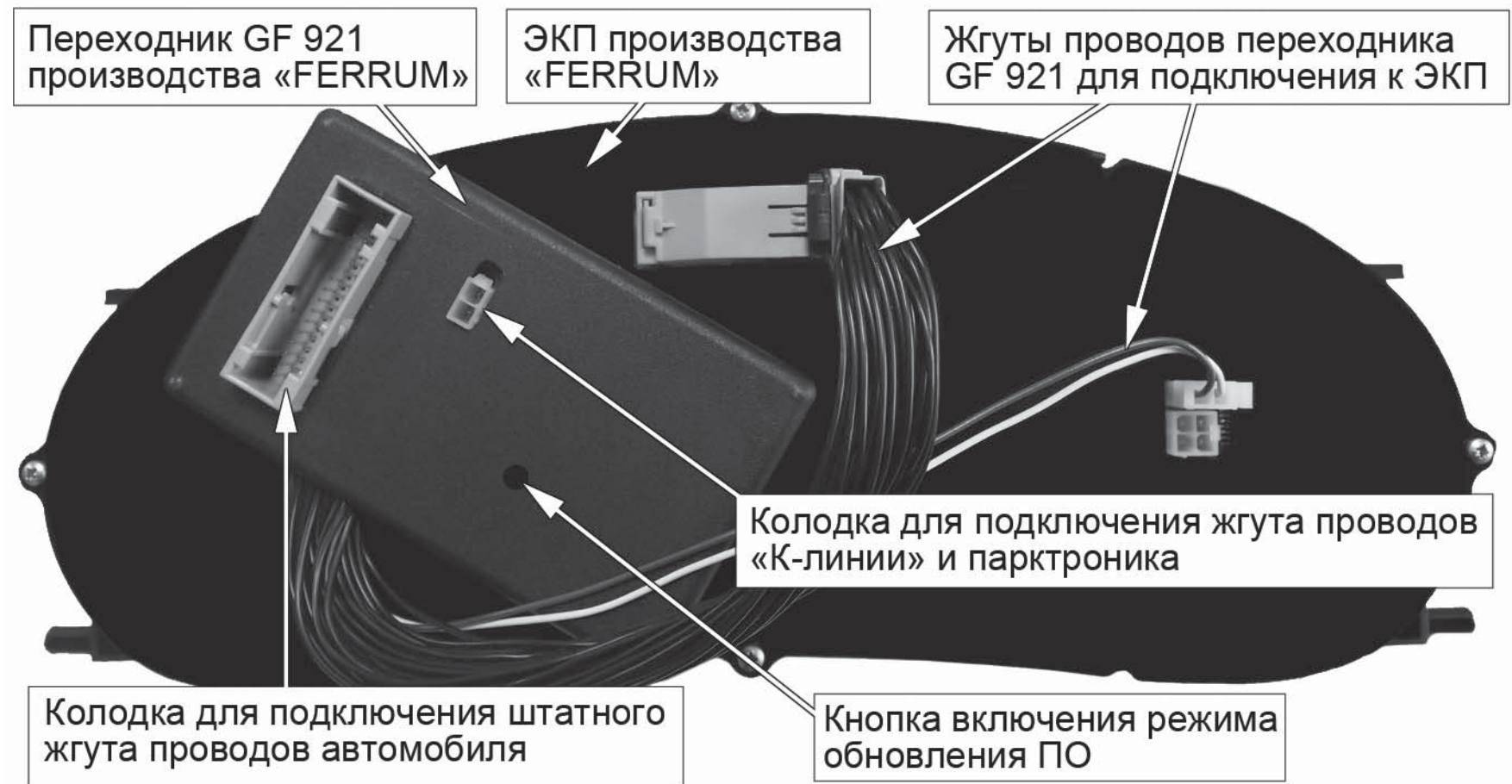
Рис.1. Установка и подключения переходника GF 921
