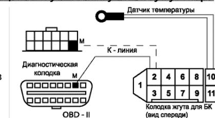
Подсоединить разъем датчика температуры к БК и установить БК на штатное место. Иные способы крепления датчика не рекомендуются, т.к. на показания датчика температуры могут влиять солнечный свет и тепло из моторного отсека автомобиля.
