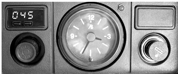
Рис. 1. Вид установленного БК в панели приборов а/м ВАЗ 2107
