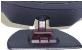
Установка компьютера на платформу
